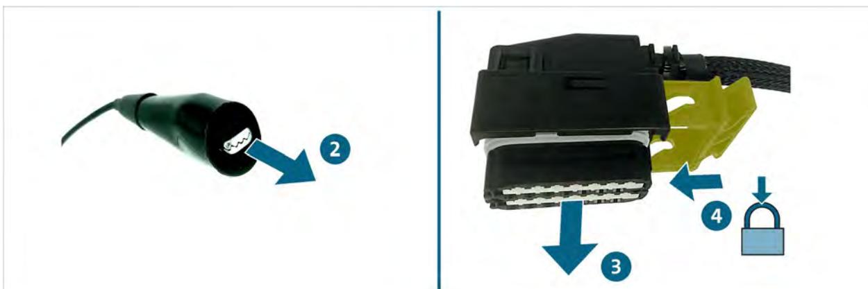
5. Conecte el conector macho del módulo de la batería (Cellbox) al conector hembra desconectado correspondiente.
