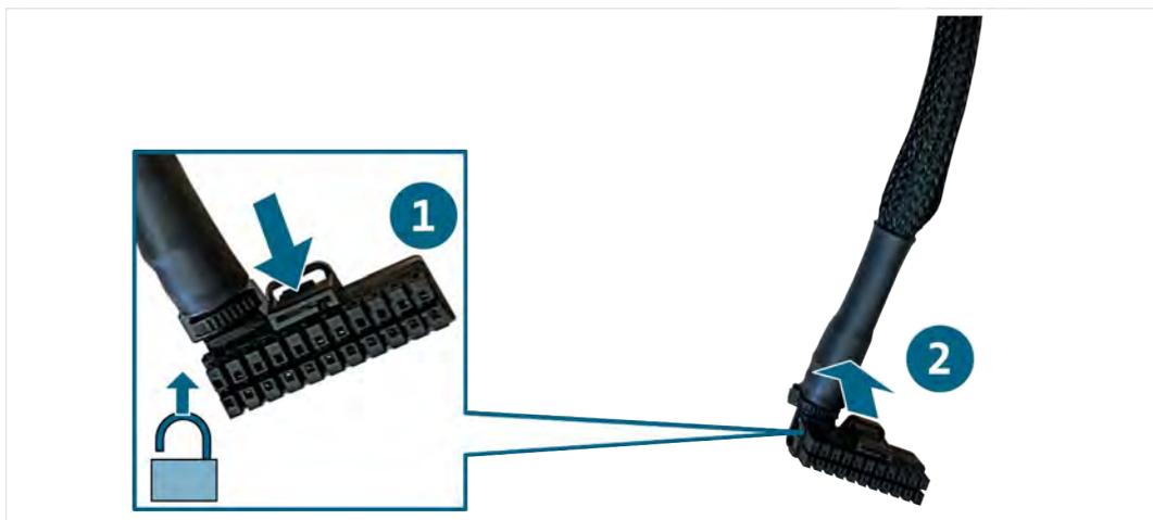
✓ Η σύνδεση βύσματος αφαιρείται.
