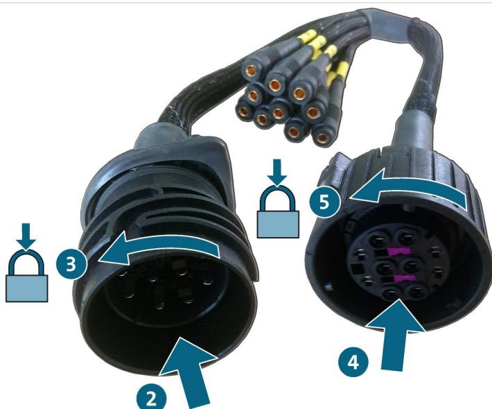
6. 가이드 고장진단에 따라 고전압 측정 모듈을 테스트 소켓에 연결하십시오.
