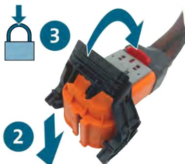
4. Verbinden Sie das Hochvolt-Messmodul gemäß der geführten Fehlersuche mit dem Hochvolt-Prüfadapter.
