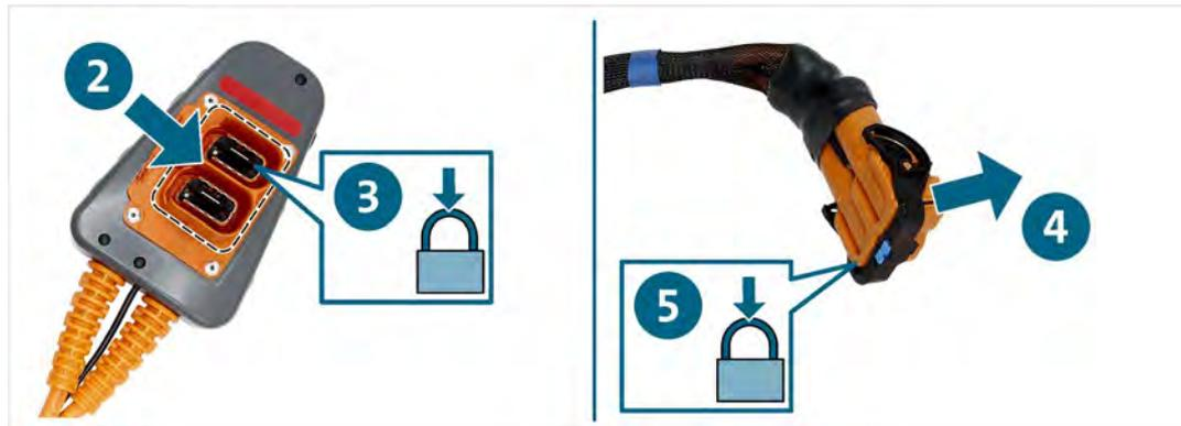
6. Verbinden Sie das Hochvolt-Messmodul gemäß der geführten Fehlersuche mit dem Hochvolt-Prüfadapter.
