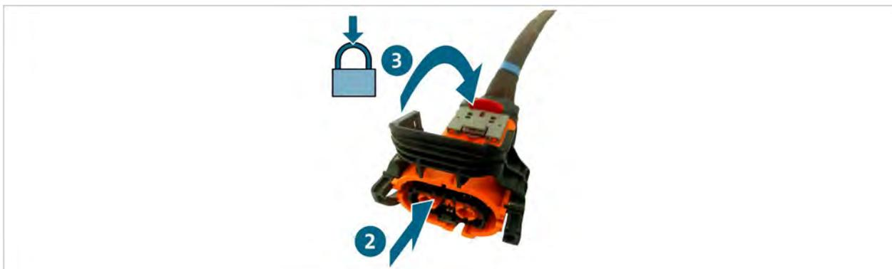
4. Branchez le connecteur à la prise débranchée de la connexion à inspecter.
