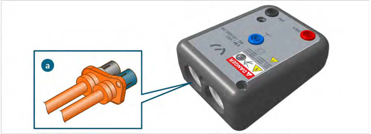
(a) 2 yollu HPK konnektörler için bağlantı soketleri
